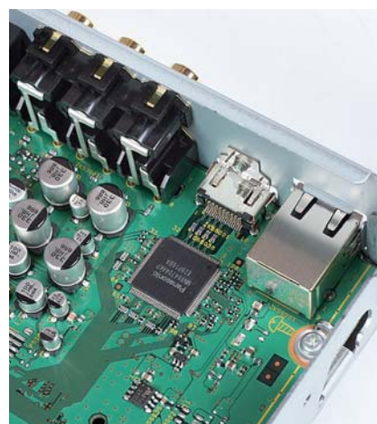
Wyjście HDMI z interfejsem firmowym Panasonic - zwykle widuje się tutaj skalaki Silicon Image.
