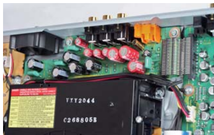
Część wyjść audio przeniesiono na oddzielną płytkę, gniazda kanałów frontowych pozostały jednak na głównym druku.
