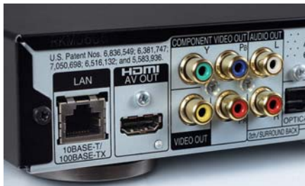
Obok HDMI ulokowano port komunikacji sieciowej LAN, wymagany w specyfikacji BD Live.
