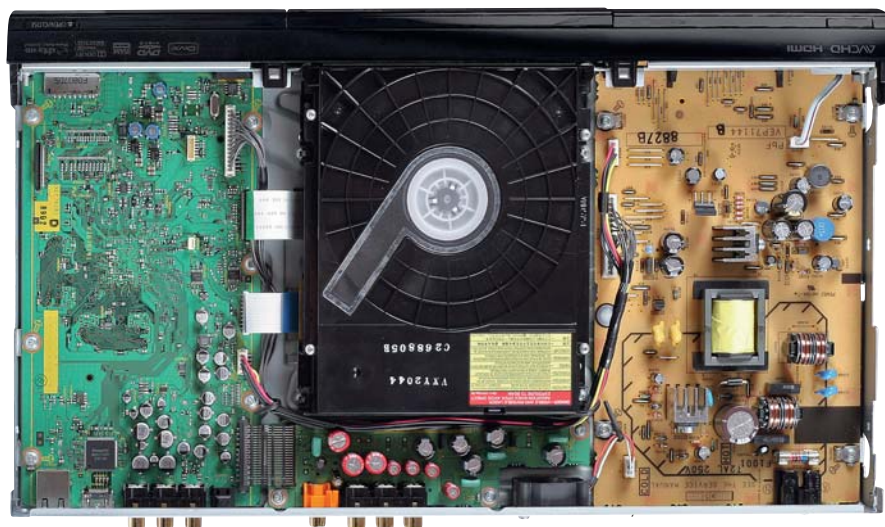
Część wyjść audio przeniesiono na oddzielną płytkę, gniazda kanałów frontowych pozostały jednak na głównym druku.
