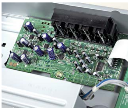
Wyjścia audio z oddzielną płytką i konwerterami sygnału AKM.
