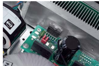
Końcówka Micromegi to pojedynczy (na kanał) scalak z serii LM. To tutaj zaoszczędzono fundusze, przekierowane do transformatorów...
