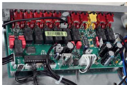
Płytkę przedwzmacniacza i logiki. Z lewej strony preamp fonowy, z prawej kostka Crystala sterująca poziomem wzmocnienia.
