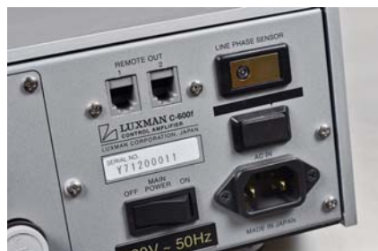
Dwa wielopinowe złącza mogą wysłać sygnały do dwóch końcówek mocy.
