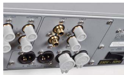
Luxman dodaje plastikowe osłonki na nieużywane gniazda XLR i RCA, chroniąc w ten sposób styki.
