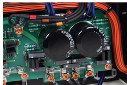
Płytkę zasilania. Napięcia rozpraszane są posrebrzаныmi przewodami.
