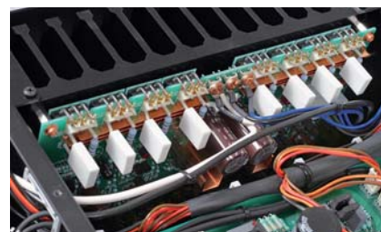
Dwa identyczne moduły wyjściowe - każdy generuje moc z ośmiu tranzystorów końcowych.
