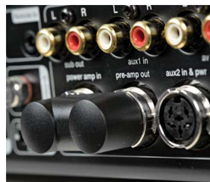
Połączenie między końcówką i przedwzmacniaczem wyprowadzono na zewnątrz i zrealizowano za pomocą zwory.
