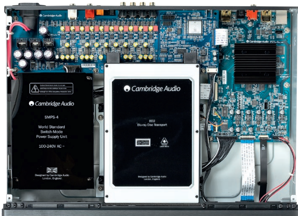
Spośród trzech sekcji najwięcej uwagi poświęcono audio: procesorom, konwerterom DAC i buforom wyjściowym.
