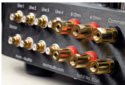
Spirita II wyposażono w osobne odczepy dla obciążenia 4 i 8 omów.
