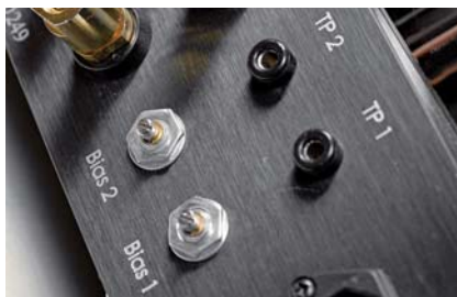
Wprawdzie na końcu każdego kanału pracuje pojedyncza lampa, jednak trzeba ustawić jej bias.
