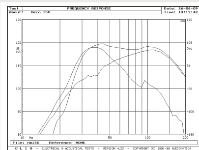
rys. 1. Charakterystyka głośnika, otworu i wypadkowa, dla najszerszego pasma.
