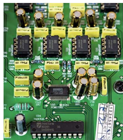
Ładnie i niedrogo: przetwornik Burr-Browna PCMI738, konwersja I/U też na scalakach tej firmy, podobnie jak wzmacnienie i buforowanie wyjścia.
