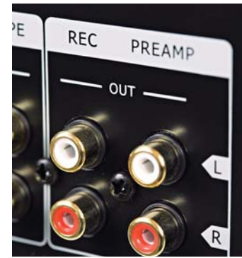
Wzmacniacz Music Halla nie ma „systemowych” fajerwerków, ale jest niezłe wyposażony: jest stereofoniczne wyjście z przedwzmacniacza, i wyjście do nagrywania ze stałym poziomem.
