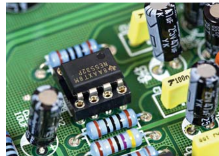
Wyjście z przedwzmacniacza buforuje pojedynczy, stereofoniczny układ scalony NE5532. Widać wysokiej klasy płytkę drukowaną i staranny montaż przewlekany.
