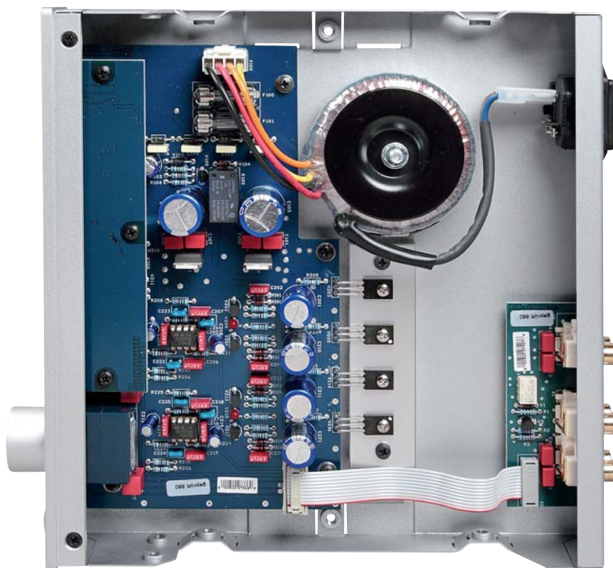
Układ zmontowano na niewielkiej płytce, a tranzystory końcowe przykręcono do obudowy.
