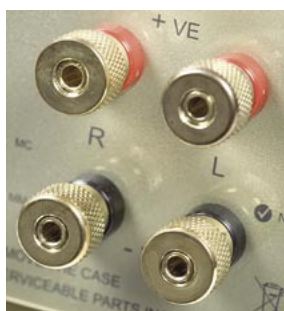
Wyjścia głośnikowe przeznaczone dla 8-omowego obciążenia.
