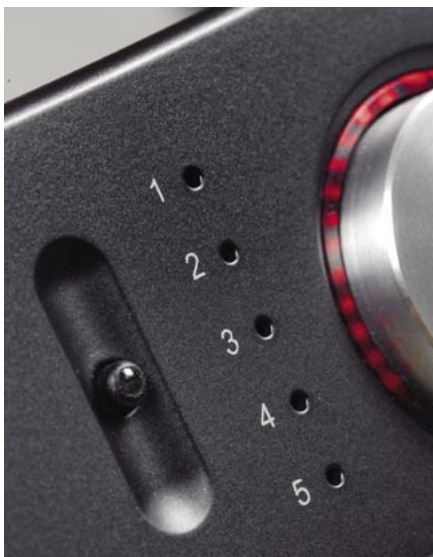
Selektor wejść z diodami, a obok gałka siły głosu – wszystko w oryginalnym stylu Regi.
