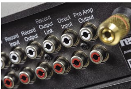
Gniazda RCA są ciasno upakowane, z włożeniem najgrubszych wtyczek może być kłopot.
