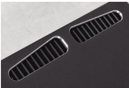
Ciepło z bocznych radiatorów odprowadzane jest przez stylowe okna w górnej pokrywie.
