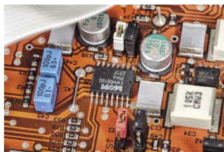
Scalona drabinka rezystorowa Wolfsona – nowoczesna regulacja głośności.
