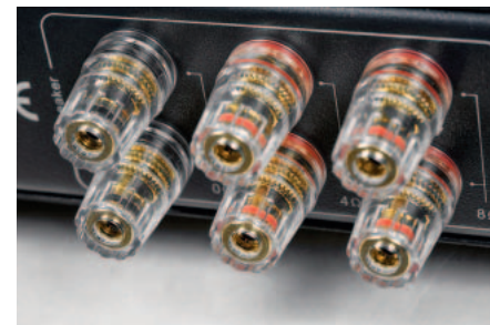
Dwa zestawy zacisków głośnikowych (a dokładnie zacisków dodatnich) wyprowadzone są z odczepów transformatorów przygotowanych dla obciążeń 4- lub 8-omowych.
