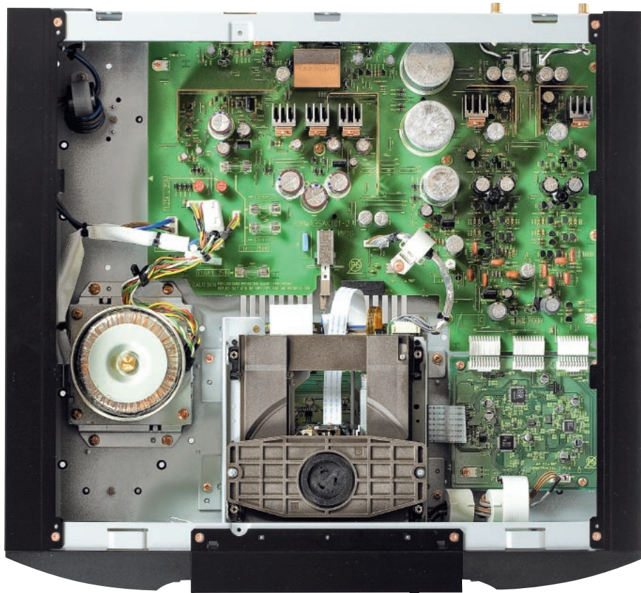
Większość układów zmieściła się na jednej dużej płytce, mniejszy druk zajmuje się obróbką sygnałów cyfrowych.
