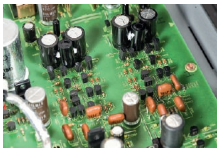
Analogowe tory sygnałowe nie zawierają wzmacniaczy operacyjnych, nie lubianych przez Marantza.
