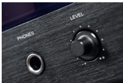
SA-15S2 ma wbudowany dobry wzmacniacz słuchawkowy z regulacją poziomu wyjściowego.
