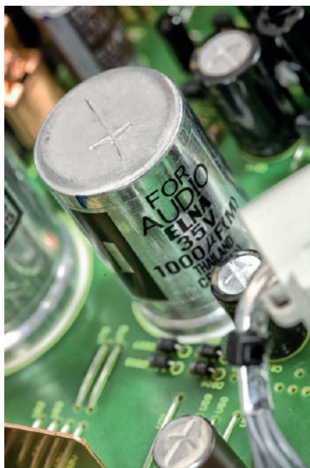
W zasilaczu zastużone dla sprawy kondensatory Elna For Audio
