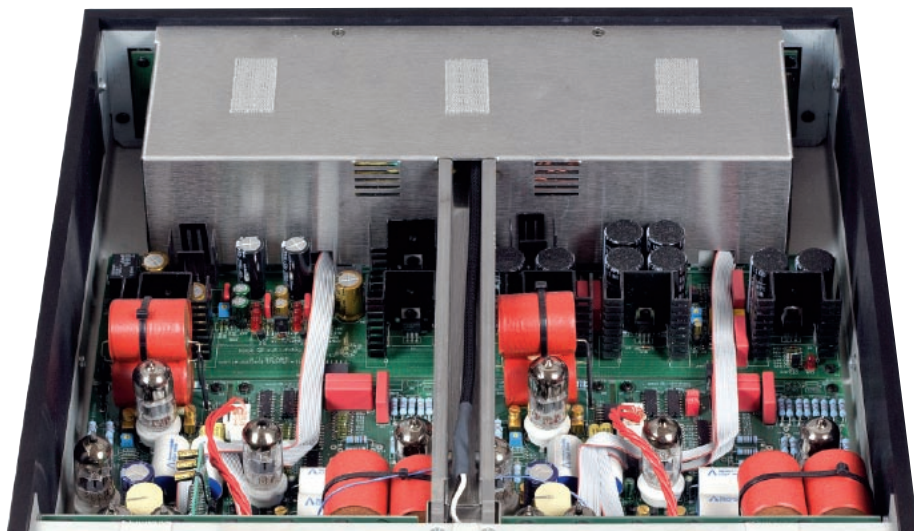
Z przodu sekcja zasilacza, a z tyłu cztery płytki – przedwzmacniacza gramofonowego i liniowego.
