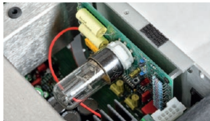
Na wejściu jest lampa – podwójna trioda z oktalowym cokołem.
