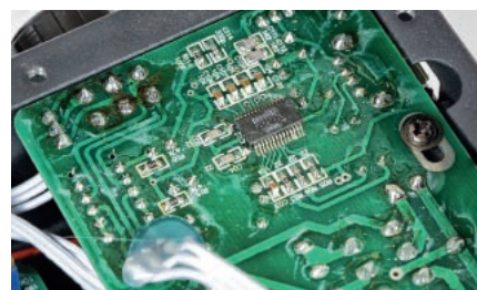
Płytkę USB ze starym układem PCM2702 to konwerter USB i DAC w jednym.
