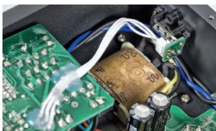
Transformatory głośnikowe są nawijane w Xindaku; wzmacniacz zoptymalizowano pod kątem 8-omowego obciążenia.
