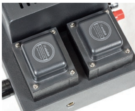
Dwa małe transformatory głośnikowe – przy „takiej” mocy większe nie są potrzebne.
