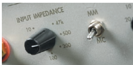
Zmiany impedancji wejściowej dokonuje się przełącznikami – osobno dla każdego z kanałów.
