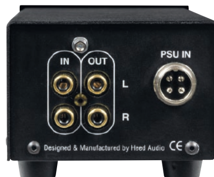
Gniazda RCA są umieszczone bardzo blisko siebie, co utrudnia manewry kablami.
