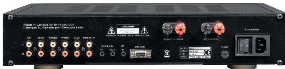
Wyposażenie w gniazda standardowe. Wyłącznik sieciowy znalazł się w tym miejscu nieprzypadkowo – firma zaleca, aby urządzenia były cały czas pod napięciem.
