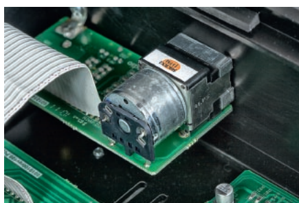
Regulacja wzmocnienia jest klasyczna – na potencjometrze Alpsa (czarnym), sterowanym silniczkiem.
