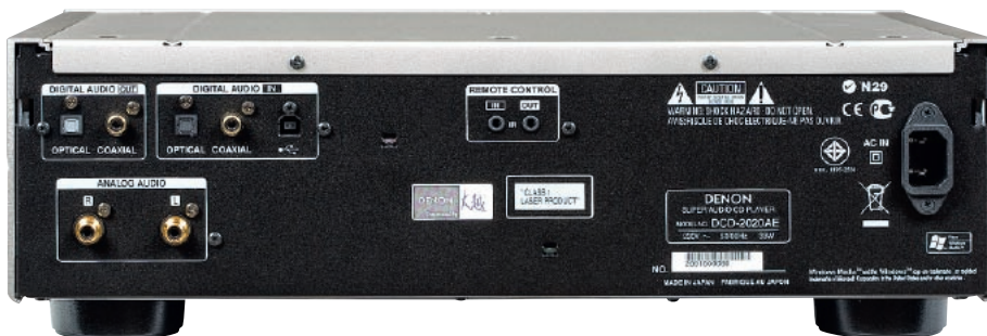
Z jednej strony DCD-2020AE jest czymś więcej niż tylko odtwarzaczem płyt – to również przetwornik C/A – ale z drugiej, jego statutowym zadaniem jest jednak odczyt CD i SACD. Dlatego analogowe gniazda wyjściowe są wyższej jakości niż gniazda cyfrowe.
