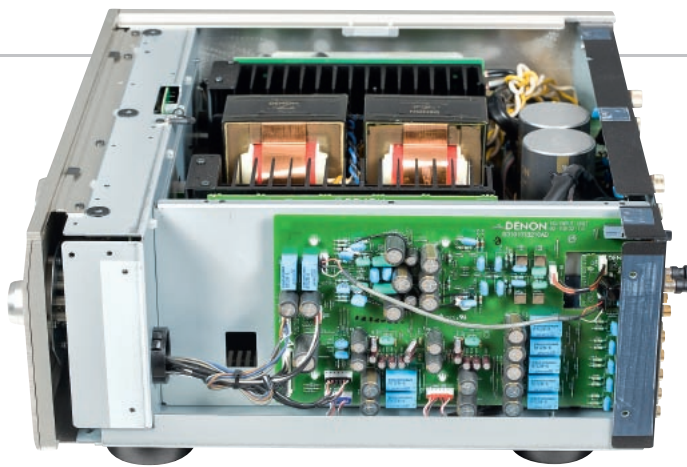
Przedwzmacniacz ma osobne zasilanie i został odseparowany od reszty układu grubą blachą ekranującą. Tor przedwzmacniacza gramofonowego (na górze) jest niemal tak duży, jak tor dla wejść liniowych.
