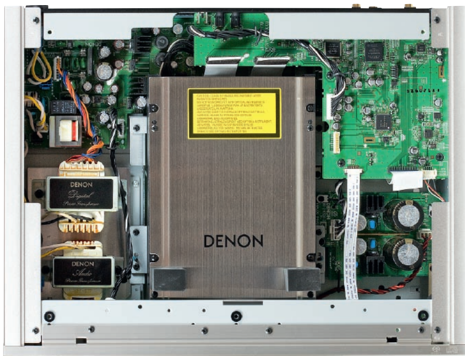
Najwrażliwszym elementem w odtwarzaczach płyt optycznych jest napęd – czuły na zakłócenia elektromagnetyczne, RF i na wstrząsy. Denon chroni go przed tymi zagrożeniami za pomocą grubego ekranu / wzmocnienia (od góry) oraz specjalnego stelażu, do którego jest mocowany napęd (od dołu)
