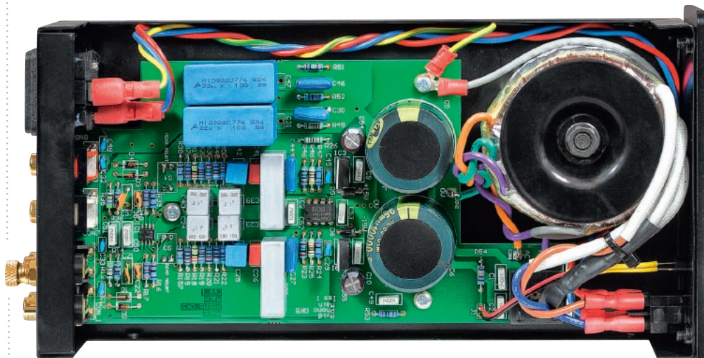
Cały układ elektroniczny zmontowano na jednej płytce – z klasycznym montażem przewlekany i dobrymi elementami biernymi. W tej samej obudowie znaleźli się też zasilacz z dużym transformatorem toroidalnym.
