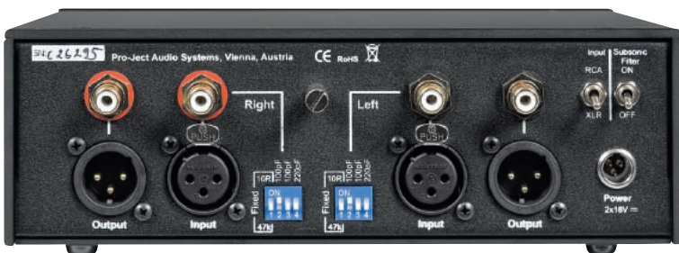
Układ elektroniczny PJ to dual-mono, z wyraźnie wydzielonymi sekcjami dla lewego i prawego kanału.
