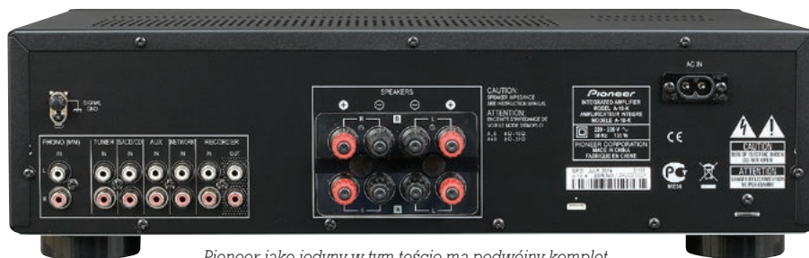
Pioneer jako jedyny w tym teście ma podwójny komplet wyjść głośnikowych, sprzężonych z przełącznikiem.
