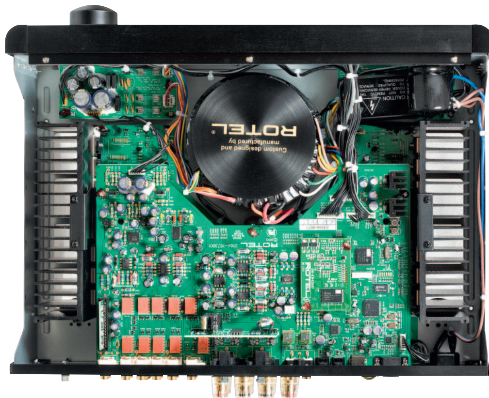
Okazały układ z niezależnymi radiatorami i dwoma głównymi piętrami układów – na dole znajdują się końcówki mocy oraz zasilacz, a na górze rozbudowany przedwzmacniacz z sekcją cyfrową.
