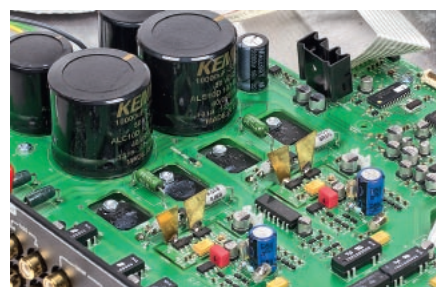
Tranzystory końcowe zostały tu przykręcone nie do radiatora, lecz do aluminiowej płytki, a ta do dna obudowy.
