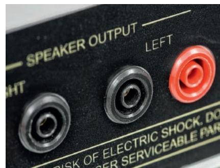
Wyjścia głośnikowe akceptują jedynie wtyki bananowe.
