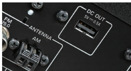
Komunikacja z siecią jest głównie przewodowa, ale specjalne gniazdo USB przygotowano do zasilania dedykowanego adaptera standardu Wi-Fi.
