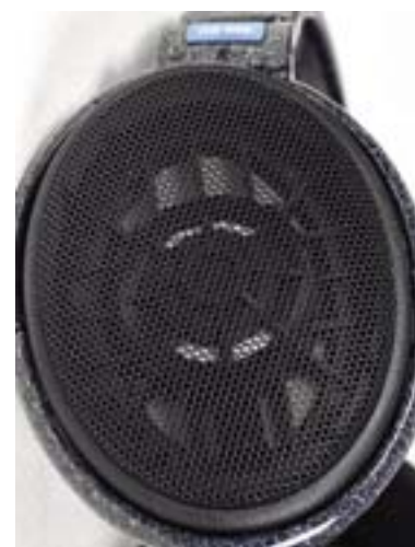
Konstrukcja otwarta – przetworniki widać przez metalową siatkę tylnej obudowy muszli.
