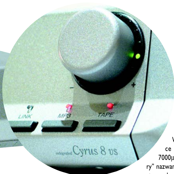
Wokół gałki siły głosu umieszczono diody, które ułatwiają odczyt poziomu.
