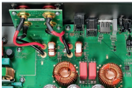
Przed samym wyjściem sygnał przechodzi przez pasywne filtry dolnoprzepustowe pełniące rolę... przetworników C/A dla sygnałów PWM.
