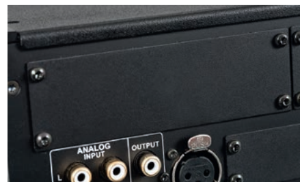
Pod kilkoma zaślepkami kryją się „zatkni” pozwalające na instalację dodatkowych kart rozszerzeń.
