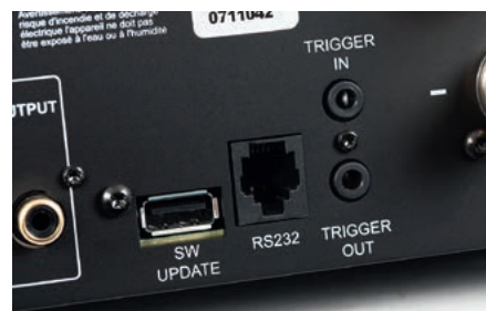
Wzmacniacz w podstawowej wersji ma już port USB, ale służy on tylko do zadań serwisowych i aktualizacji oprogramowania.
