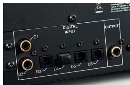
Wejścia cyfrowe to najlepsza droga dostarczenia sygnału do wzmacniacza pracującego na zasadzie konwersji PCM do PWM.
