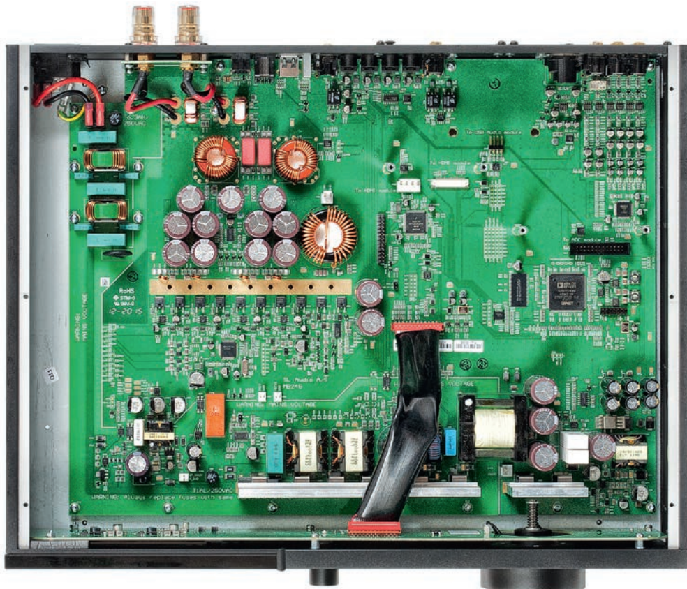
Wnętrze urządzenia przypomina przedwzmacniacz – nie ma ani dużego transformatora zasilającego, ani typowego radiatora.
