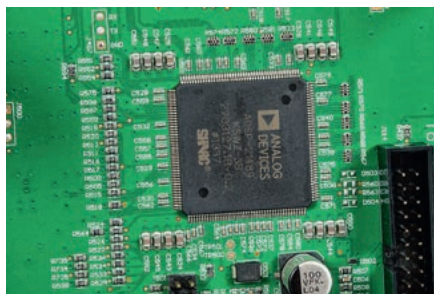
Procesor DSP Analog Devices z gamy Sharc jest często stosowany w sprzęcie wielokanałowym – tutaj odpowiada za obróbkę sygnału na potrzeby systemu kalibracji.
