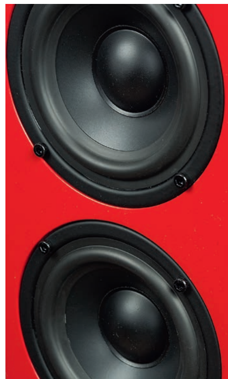
Dwa 11-cm nisko-średniotonowe (średnica membran - 7,5 cm) mają łączną powierzchnię drgającą mniejszą niż jeden głośnik 18-cm, na duże wychylenia też nie ma co liczyć, dlatego nie należy spodziewać się potężnego basu.
