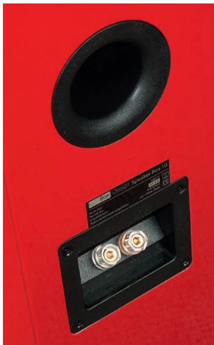
Otwór bas-refleks ma średnicę tylko 4,5 cm i 10-cm tunel, wraz z niewielką objętością obudowy (ok. 15 litrów), układ bas-refleks dostrojony jest dość wysoko (ok. 55 Hz).
