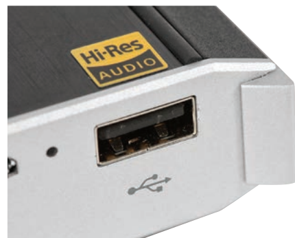
Typowe gniazdo USB Typ-A służy do podłączenia mobilnego sprzętu Apple, z którego prześlemy sygnał cyfrowy. Można tutaj także podładować akumulator iPod'a.
