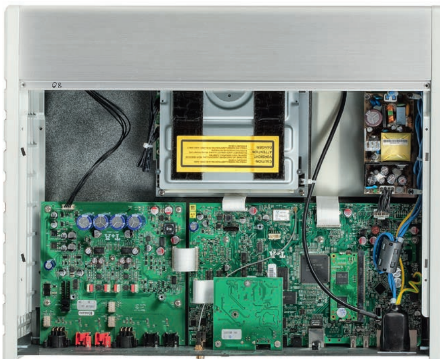
Wnętrze podzielono na sekcję przetwornika C/A (z wyjściami), mechanizm oraz dużą płytkę procesorów, zadaniem których jest zbieranie, dekodowanie i rozdzielanie sygnałów ze wszystkich źródeł.
