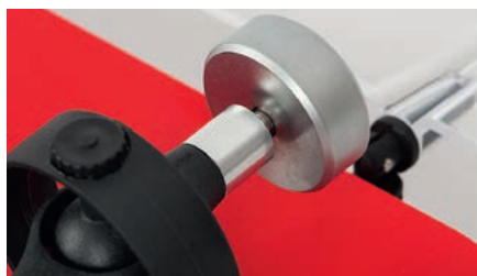
Przeciwwagę wkręcamy na metalowy trzpień regulując w ten sposób siłę nacisku igły; ten parametr, co wyjątkowe, został już ustawiony fabrycznie, gramofon ma już wkręconą przeciwwagę.
