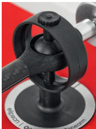
Przeciwwagę wkręcamy na metalowy trzpień regulując w ten sposób siłę nacisku igły; ten parametr, co wyjątkowe, został już ustawiony fabrycznie, gramofon ma już wkręconą przeciwwagę.
