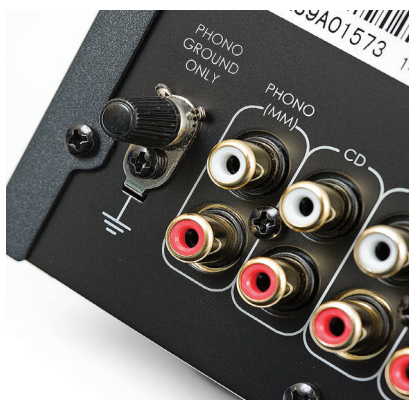
Standardowe wyposażenie obejmuje wbudowany przedwzmacniacz gramofonowy (wkładki typu MM).
