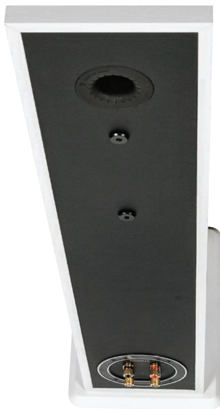
Na tylnej ścianie stwierdzamy obecność dwóch łbów śrub - trzymają one głośniki nisko / nisko-średniotonowe; widoczny na górze wylot bas-refleksu prowadzi z górnej, mniejsze komory nisko-średniotonowego.
