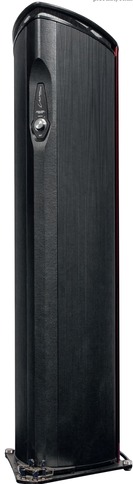
26-cm głośnik niskotonowy ukryto na dole, ciśnienie rozchodzi się dzięki wysokim kolcom, z czego korzystają też dwa otwory bas-refleks – te jednak pracują z głośnikami niskotonowymi, zainstalowanymi na przedniej ściance.
