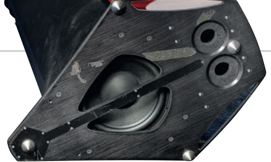
26-cm głośnik niskotonowy ukryto na dole, ciśnienie rozchodzi się dzięki wysokim kolcom, z czego korzystają też dwa otwory bas-refleks – te jednak pracują z głośnikami niskotonowymi, zainstalowanymi na przedniej ściance.
