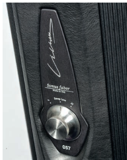
Trójpozycyjny przełącznik pozwala na regulację sekcji subniskotonowej; trudno a priori ustalić optymalny kształt charakterystyki i poziom najniższego basu dla każdego pomieszczenia i każdego ustawienia.
