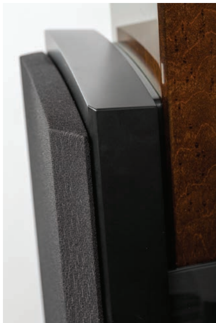
Projektant chciał podkreślić autonomię i wielowarstwowość głośnikowego panelu; oddzielił go od głównej skrzyni dodatkową płytą i przykrył wyjątkowo grubą maskownicą (2 cm).
