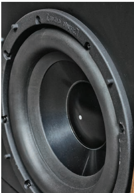
Głośnik niskotonowy ma wyraźne cechy subniskotonowego, przystosowanego do pracy z bardzo dużymi amplitudami. Dwa takie głośniki w jednej kolumnie, a więc w sumie cztery w parze Cardeasów... Przy odpowiedniej mocy wzmacniacza będzie możliwe osiągnięcie bardzo wysokich poziomów.
