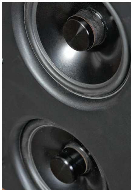
Już z zewnątrz widać różnice między „15-tkami” nisko-średniotonowymi (na zdjęciu dolna) a „1,5-tką” średniotonową – inaczej wygląda korpus korektora fazy.
