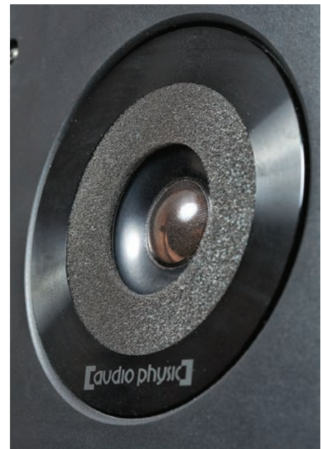
Na pierwszy rzut oka można by sądzić, że przed jedwabną kopułką uformowano krótką tubkę – występującą w wielu współczesnych tweeterach. Jednak w tym przypadku jest to główna, aluminiowa część membrany.
