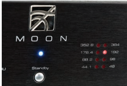
Dla samej sekcji PCM przygotowano osiem diod odpowiadających osiemu głównym częstotliwościom próbkowania sygnału.
