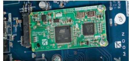
Niektóre obudowy przeniesiono na dodatkowe płytki drukowane, co ułatwi ich wymianę, gdy zajdzie potrzeba ulepszenia tych komponentów – tak jak w przypadku modułu wejścia USB.
