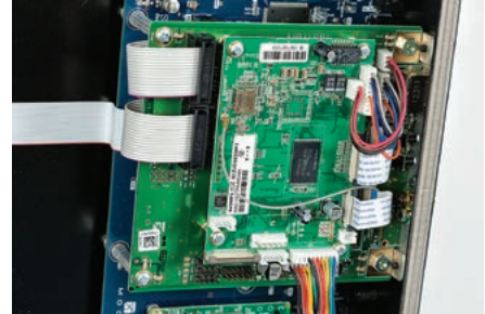
Dwie płytki przykręcone na wspornikach tworzą moduł Mind, realizują funkcje komunikacji sieciowej oraz dekodowania plików.
