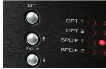
Wejść jest sporo, a ponadto Bluetooth i moduł sieciowy Mind; przełączanie odbywa się sekwencyjnie, za pomocą dwóch przycisków.
