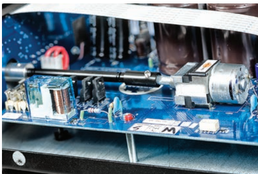
Potencjometr analogowy zainstalowano w sekcji przedwzmacniacza, łącząc za pomocą długiego trzpienia z gałką na przedniej ściance.
