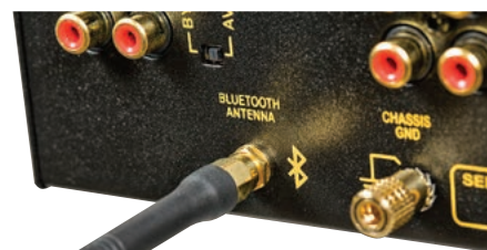
Obudowa jest w całości metalowa, więc konieczna była zewnętrzna antena dla transmisji Bluetooth.
