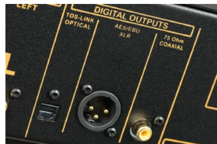
Wejść cyfrowych brak, ale wyjścia mamy w dużym wyborze – jest nawet standard AES/EBU.
