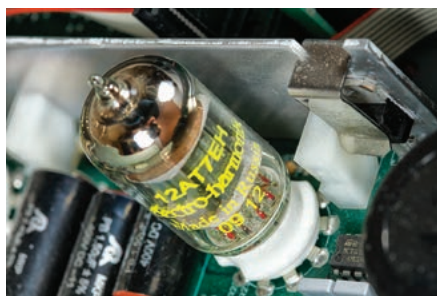
W sterowaniu pracują podwójne triody 12AT7EH Electro-Harmonix.
