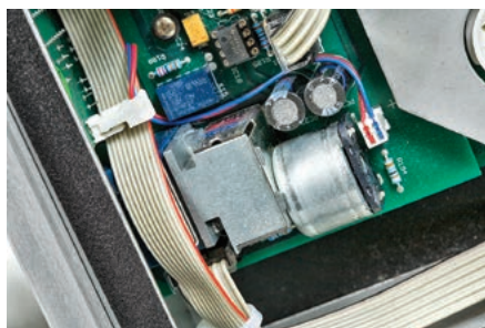
Potencjometr jest napędzany przez silniczek.
