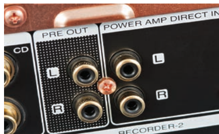
Marantz przygotował specjalny tryb (oraz gniazda przyłączeniowe), który pozwala połączyć dwa wzmacniacze w układzie bi-amping.
