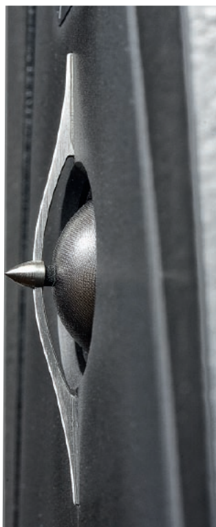
29-mm jedwabna kopułka jest „przytrzymywana” w centralnym punkcie, narażonym na największe odkształcenia przez podstawę szpica – pomiędzy nim a kopułką umieszczono malutki walec z gąbki. Genialnie proste...
