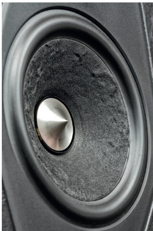
„Pomarszczona” membrana „18-tki” wraca do łask – ale tym razem w komplecie ze zupełnie nowym koszem i neodymowym układem magnetycznym.
