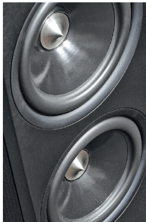
Podobne, ale większe antykompresory – bo wewnątrz cewek drgających o większej średnicy – mają głośniki niskotonowe; ich membrany są sandwichowe (zewnątrznie idealne warstwy celulozowe, wewnętrzna pianka syntetyczna).
