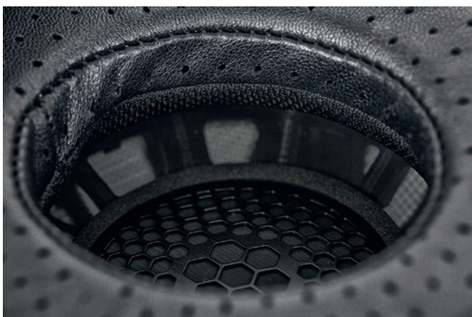
Poduszki na muszlach, podobnie jak na pałaku, obszyte są delikatną skórą owczą, i podziurkowane (wraz ze znajdującą się wewnątrz gąbką) dla uzyskania optymalnych parametrów.
