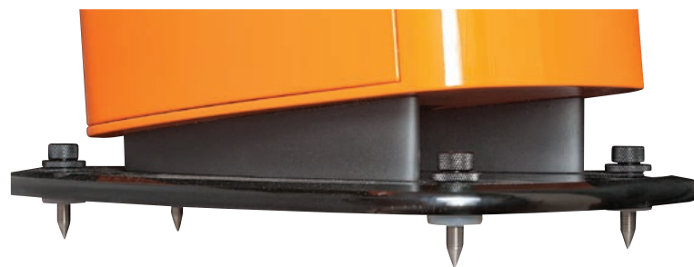
Cokół wycięto z grubej tafli szkła, pomiędzy nim a obudową znajduje się wylot układu rezonansowego bas-refleksu. Kolce są grube i długie, umożliwiają wyregulowanie pozycji kolumny i skierowanie jej osi głównej w miejsce odsłuchowe.
