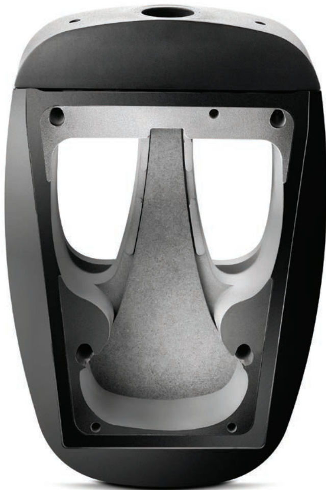
Skomplikowane wycięcia wewnątrz modułu średniotonowego tworzą komorę głośnika średniotonowego i kanały, które łączą dolny moduł (niskotonowy) z częścią modułu górnego (średniotonowego), powiększającą objętość komory niskotonowej.
