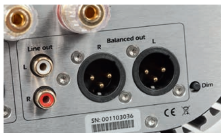
Gato ma nawet dwa wyjścia z przedwzmacniacza, w standardzie symetrycznym i niesymetrycznym.
