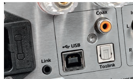
Gniazda wejściowe to tylko jedna część cyfrowego świata DIA-250S , priorytetowe są złącza USB oraz koaksjalne, akceptujące sygnały PCM 24/192.
