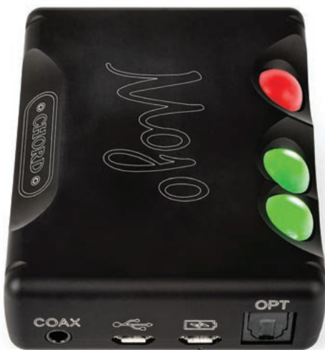
Koaksjalny, USB, optyczny - są wszystkie „zasadnicze” wejścia cyfrowe, ale w formatach mikro, wymuszonych przez wielkość urządzenia.
