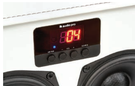
Wyświetlacz znajduje się pod maskownicą, lecz matryca jest jasna, więc z czytelnością nie będzie problemów, obsługę zapewni pilot lub np. smartfon.
