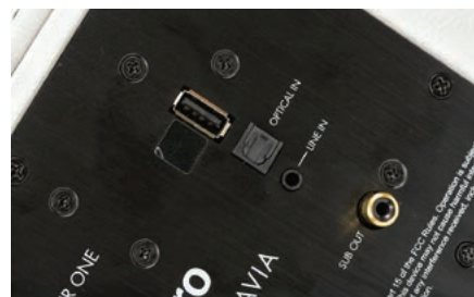
Większość sygnałów ma płynąć bezprzewodowo, ale do Air One podłączymy również kablem źródła cyfrowe i analogowe.
