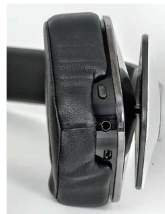
W dolnej części jednej muszli znajduje się gniazdo analogowe mini-jack oraz złącze USB, przez które ładujemy akumulatory (potrzebne do działania wibracji) oraz aktualizujemy oprogramowanie słuchawek.
